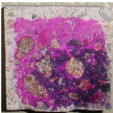
Rysunek 9. Próbką betonowa – karbonatyzacja powierzchniowa [W4]
