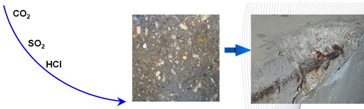
Rysunek 2 Korozja chemiczna i jej skutki
