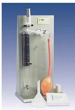
Rys. 6. Aparat Blaine'a do badania powierzchni właściwej cementu.
