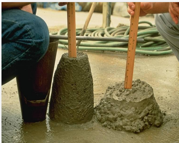
Rys. 3. Badanie konsystencji mieszanki betonowej – wpływ popiołu lotnego na urabialność mieszanki betonowej ( http://www.unb.ca/civil/bremner/CIRCA/WebPages/Circa_6_Use_in_a.htm )
